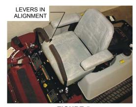
FIGURE 5 LEVER ALIGNMENT
