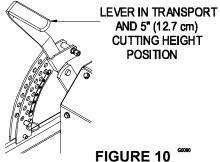
FIGURE 10 CUTTING HEIGHT POSITION
