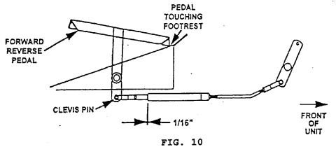
MOTION CONTROL LINKAGE ADJUSTMENT
