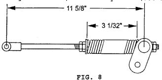
BRAKE CONTROL LINK AND SPRING ADJUSTMENT
