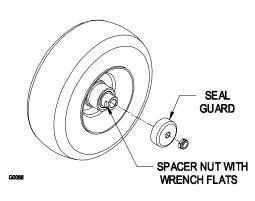
FIGURE 8 CASTER WHEEL ASSEMBLY
