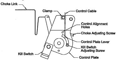
FIG 2 KOHLER SPEED CONTROL (THROTTLE CABLE HOOK-UP)
