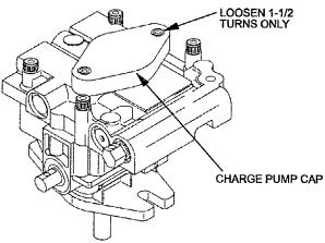
FIG. 8 CHARGE PUMP LOCATION
