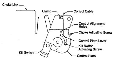
FIG 2 KOHLER SPEED CONTROL (THROTTLE CABLE HOOK-UP)
