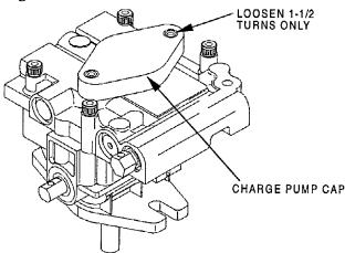
FIG. 10 CHARGE PUMP LOCATION
